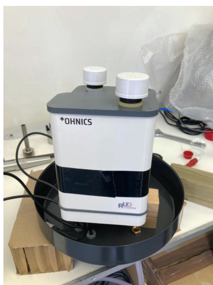
Figuur 1. Sensoren met een HEPA filter om stofloze lucht te meten
